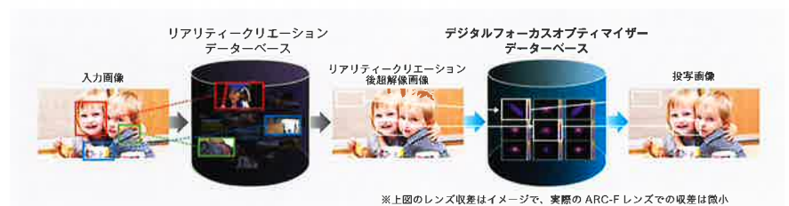
デジタル処理でMTFを向上。レンズの収差を最適化し理想的な4K映像を再現するデジタルフォーカス最適マイザー
