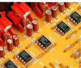
バックアンプとカップリングコンデンサー
