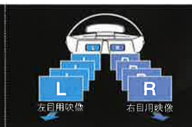
クロストークが発生しないデュアルパネル3D方式
