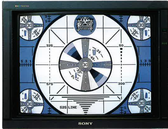
EDベータで録画した画像(水平解像度約500本)
