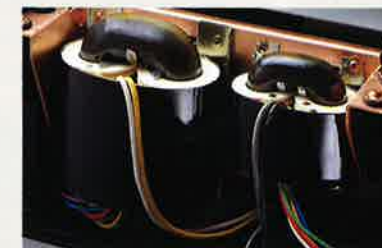
オーディオ系、ビデオ・サーボ系とも高性能R-コアドランスを使ったツイントランス方式。しかも不要振動を防ぐフローティングシステムを採用。
